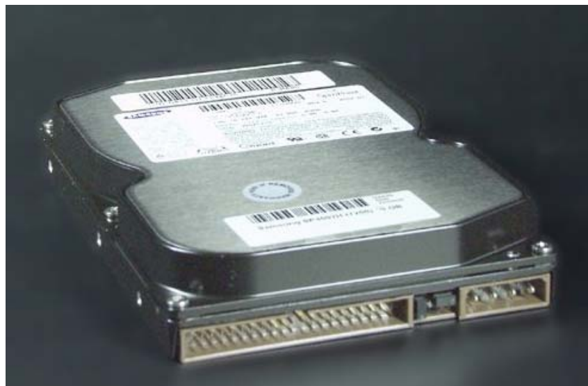
Abb.7: Eine Festplatte: rechts ist der Stromanschluss zu sehen, links der Anschluss für das Datenkabel.
