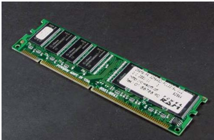
Abb.5: Ein handelsüblicher „RAM-Speicherriegel“ mit der Kapazität von 256 Megabyte.
